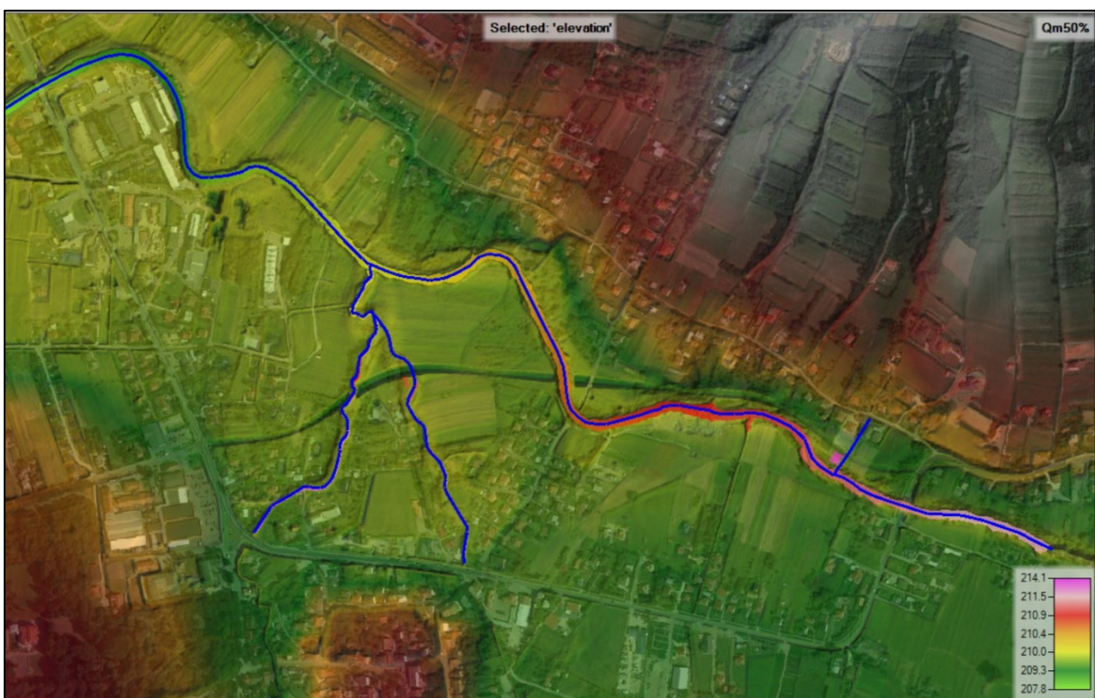
Rysunek 25 Zakres zalewu dla przepływu Q_{m50\%} wraz z poziomem lustra wody
