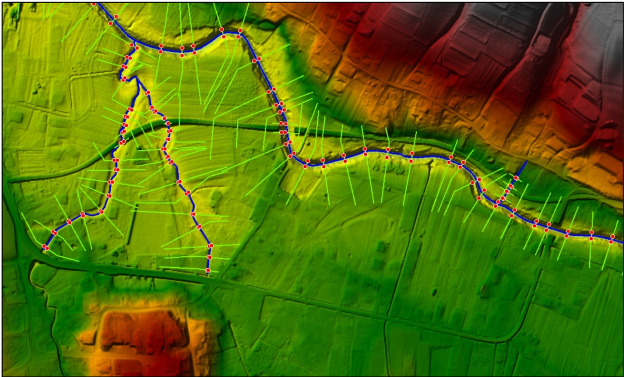
Rysunek 24 Numeryczny Model Terenu (NMT) uwzględniający projektowaną obwodnicę z zaznaczonymi przekrojami potoku Hermanowa, rowów i rzeki Strug – model RAS Mapper.
